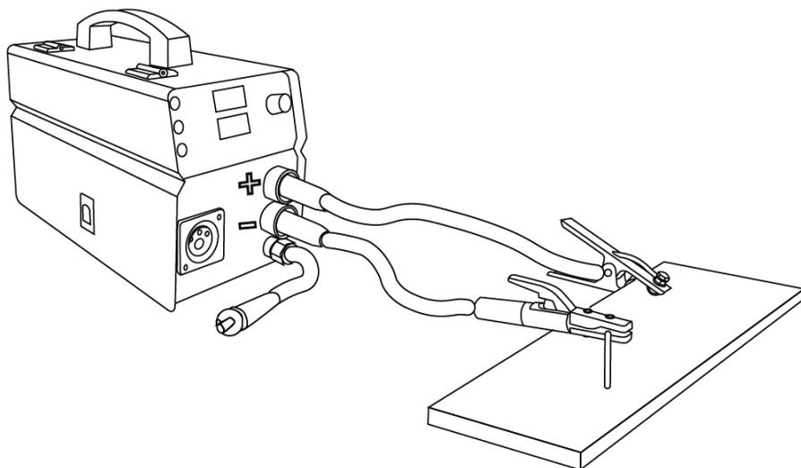
Для ММА сварки на обратной полярности подключите кабель с электрододержателем к положительному силовому разъему, а кабель с клеммой заземления к отрицательному силовому разъему.
