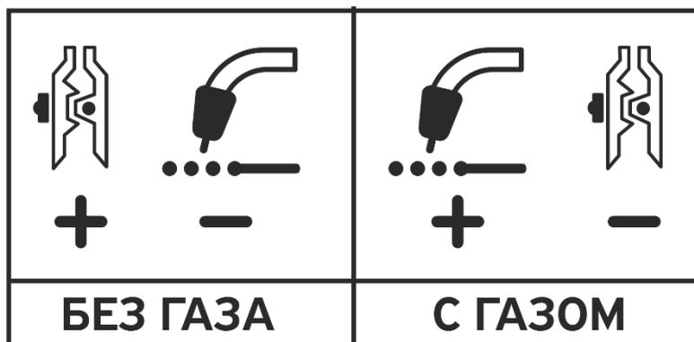
При сварке в режиме MIG/MAG в среде защитного газа проволокой сплошного сечения провод выбора полярности на передней панели сварочного аппарата должен быть подключен к «+» (положительному)
