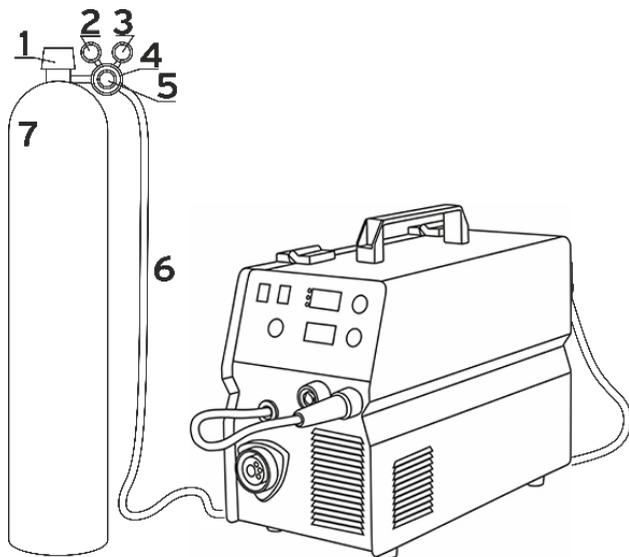
1. Вентиль баллона: используется для контроля давления газа из баллона.
