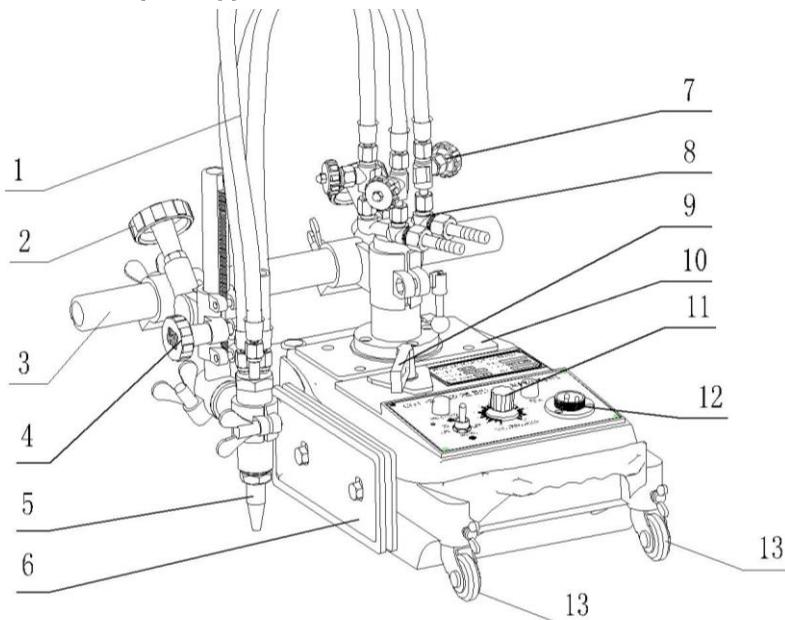
1. Шланг: Три шланга используются по отдельности для подачи горючего газа (пропан/ацетилен), кислорода продувочного и кислорода режущего;
