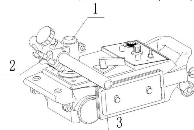
3. Установите узел подъемного устройства №4 на поперечную зубчатую штангу №3, отрегулируйте угол наклона №3 и зафиксируйте положение винтом;
