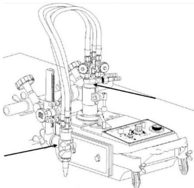
5. Затяните винт и зафиксируйте газовый резак на подъемном механизме;
