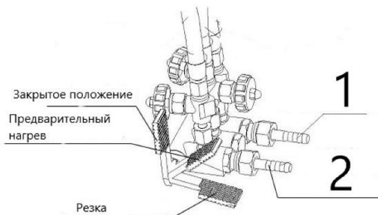
Для быстрой смены режима работы воспользуйтесь специальным рычагом. Рычаг имеет три положения: закрытое положение – газ не поступает; предварительный нагрев – возможно осуществлять нагрев детали, прежде чем начать резку; резка – включает режущий кислород для осуществления процесса резки.
